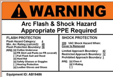
distancias de protección de arco eléctrico y las distancias de aproximación limitada, restringida y prohibida. Toda esta información estará plasmada en tarjetas normalizadas ubicadas, visiblemente, en cada equipo eléctrico. De esta forma la persona que vaya a realizar labores de mantenimiento puede saber el nivel de riesgo al que está expuesta y que equipo de protección debe de usar. Afortunadamente existen
